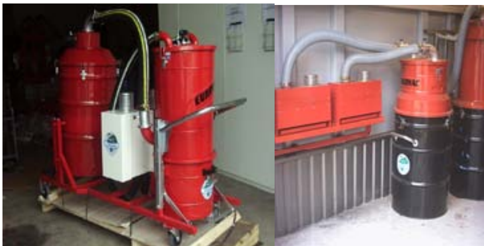
Bilden visar C-4800 och tippbar 200L fat med cyklonlock samt 53 starfilter som en mobil sugenhet med hjulunderede.
