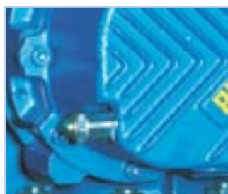
Kontroll av oljenivån
