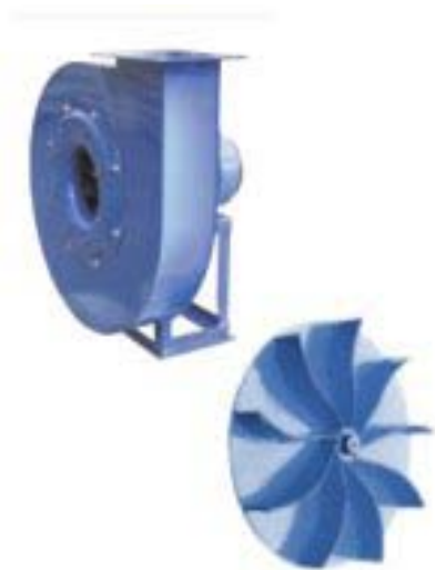
Framåtböjda skovlar för en säker transport av stoft och spannmål.
