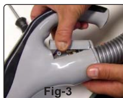
Fig-3. Demontera locket enligt bilden.
