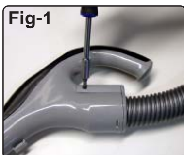
Fig-1. Skruva loss skruven som är placerad på vänster sida om handtaget.
