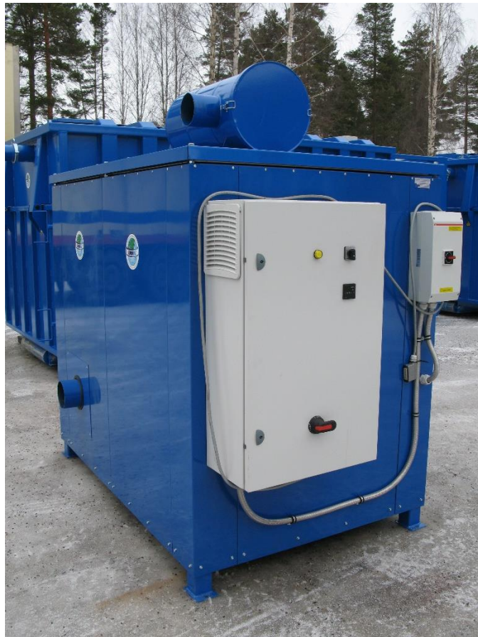
Bilden visar 75kW rootspump i eget bullerhus
