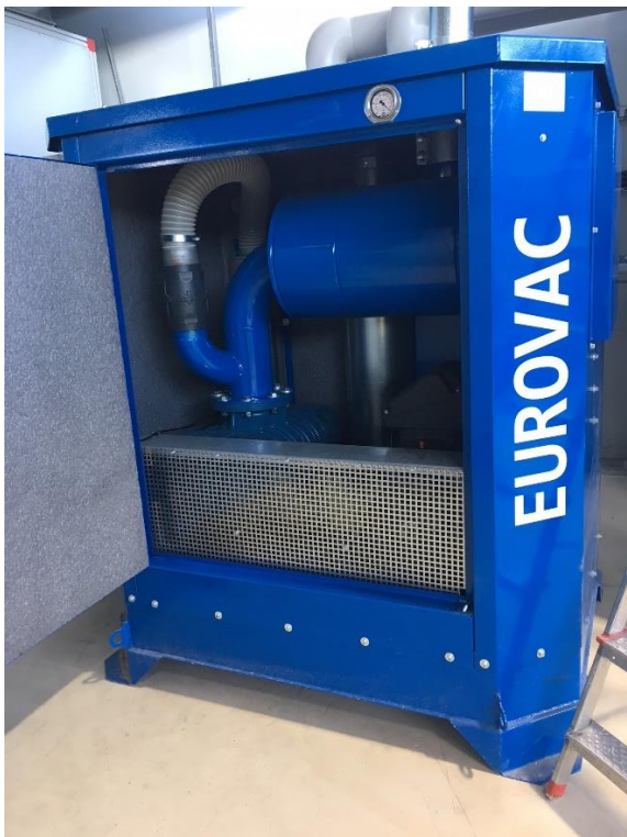
Bilden visar 45kW rootspump i eget bullerhus
