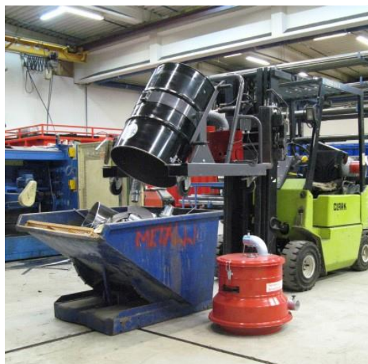
Enkel tömning i öppen avfallscontainer
