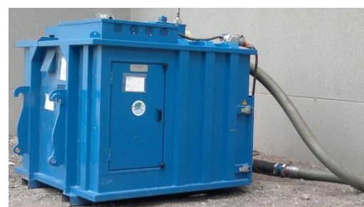
Bilden visar filtercontainer 2m 3 med integrerat sugaggregat 25kW sidokanalsfläkt
