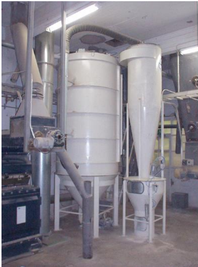
Bilden visar slangfilter 1400 och SPC-70 cyklon med utmatning till skruv
