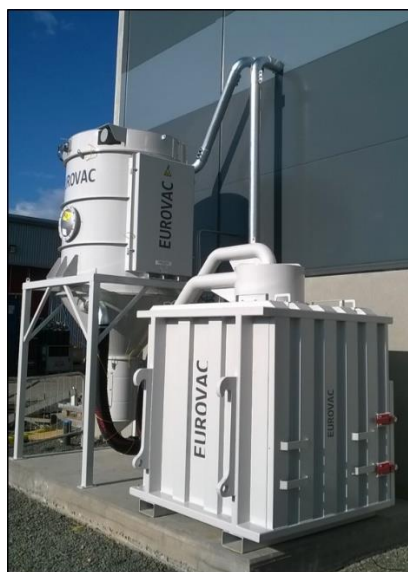
Bilden visar filterenhet 1400 med tillbakaspolning av stoft
