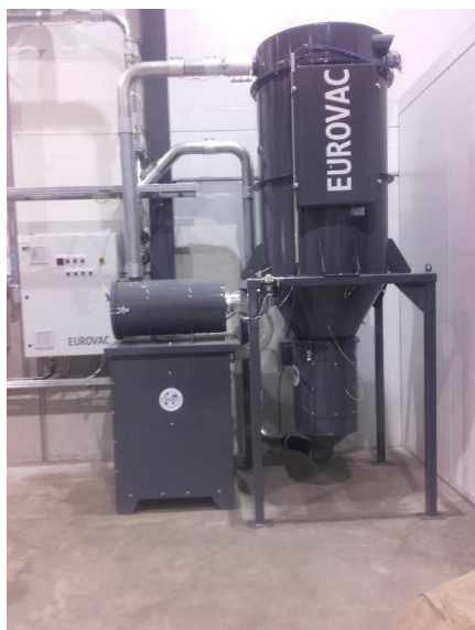
Bilden visar filterenhet 900 med tillbakaspolning av stoft
